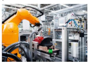
effizient verarbeiten kann. Die Funktion Power over Data Line (PoDL) vereinfacht die Verkabelung entlang des Roboterkörpers, indem sowohl Daten als auch Strom über ein einziges Kabel übertragen werden.
